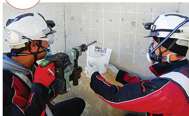
高速道路の橋脚部分のドリル法による塩分調査を行いました。ドリル削孔により採取した切削粉を使用し、協力会社にて含有塩分量調査を実施。令和元年度はドリル法、コア抜きによる塩分調査案件を多く担当させていただきました。
